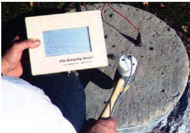
Figura 5. Detalhe do ensaio PIT (Hussein e Likins 2005)
