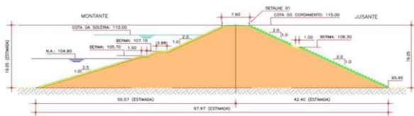
Figura 4. Seção geométrica da barragem Forquilha. (Fonte: DNOCS)
