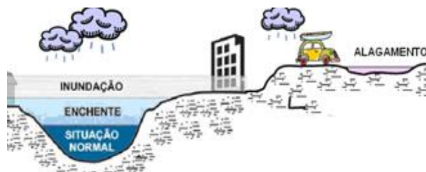
Figura 1. Perfil esquemático de enchente, inundação e alagamento. (Defesa Civil de São Bernardo dos Campos – SP, 2011).
