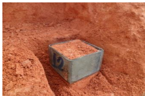
Figura 6. Escavação para obtenção de amostragem indeformada.
