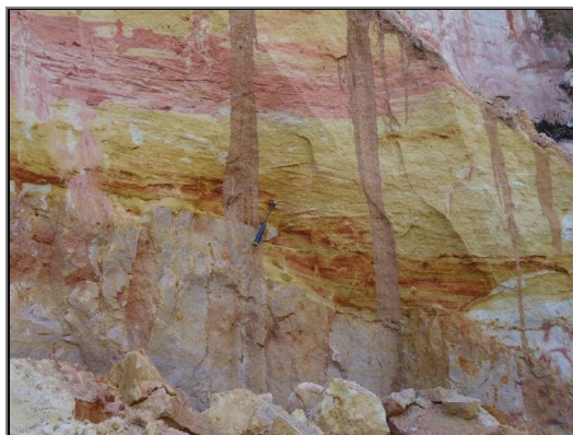
Figura 3. Camada arenosa estratificada intercalada com camada de argila maciça.
