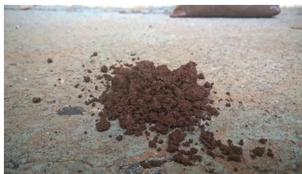
Figura 3. Solo residual de basalto retirado do talude.
