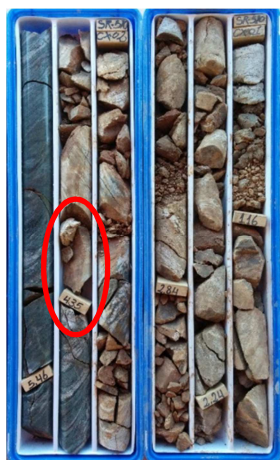
Figura 4. Foto dos testemunhos de uma das sondagens realizadas para investigar o contato H3.2/H2
