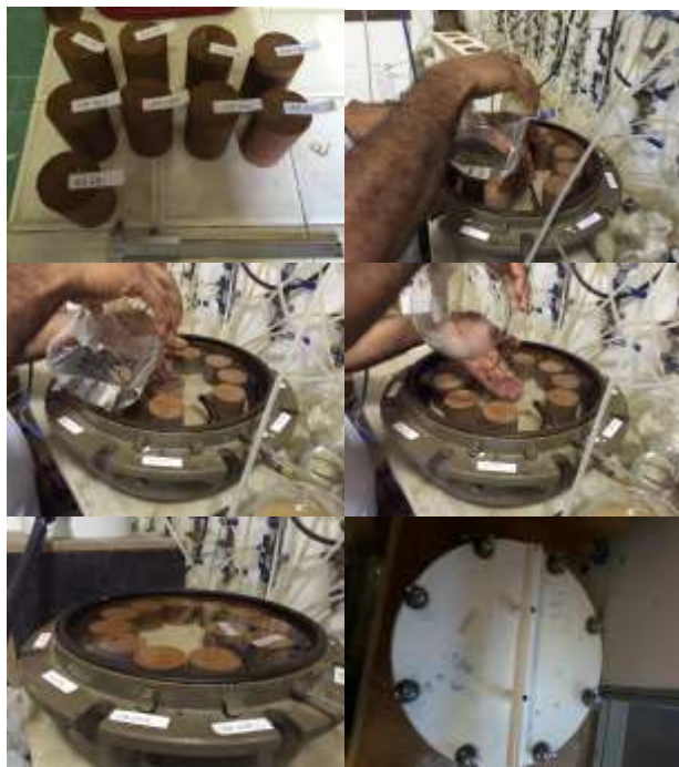
Figura 1 – Processo de saturação e aplicação de sucção na câmara de Richards.
