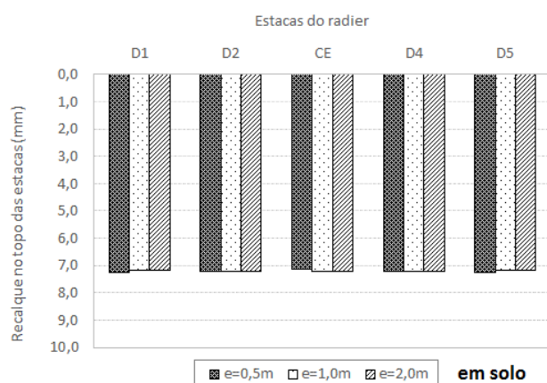
Figura 9. Distribuição do recalque no topo das estacas inseridas em subsolo sem rocha (linha B).
