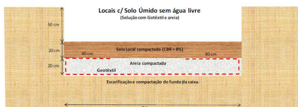
Figura 8 – Seção tipo da solução com Geotêxtil.
