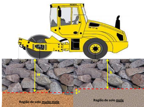
Figura 16 – Variação da penetração (agulhamento) em função da resistência superficial do solo.
