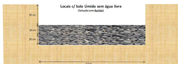
Figura 4. Seção tipo da camada de Rachão.
