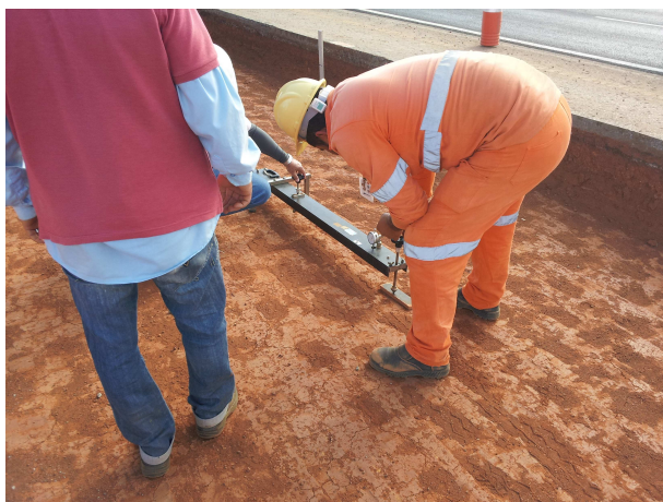
Figura 14 – Ensaio com a viga Benkelman.
