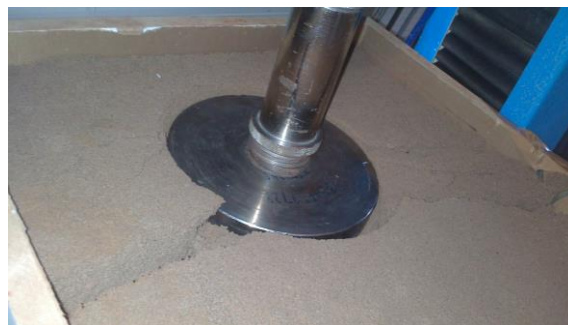
Figura 9. Aplicação da sobrecarga na superfície posterior do modelo (muro sem reforço).
