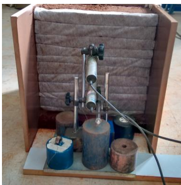
Figura 8. Face do modelo com reforço e posicionamento dos LVDTs.
