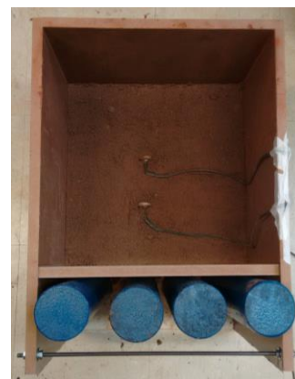
Figura 7. Montagem do modelo sem reforço: solo compactado, células de tensão e anteparo.
