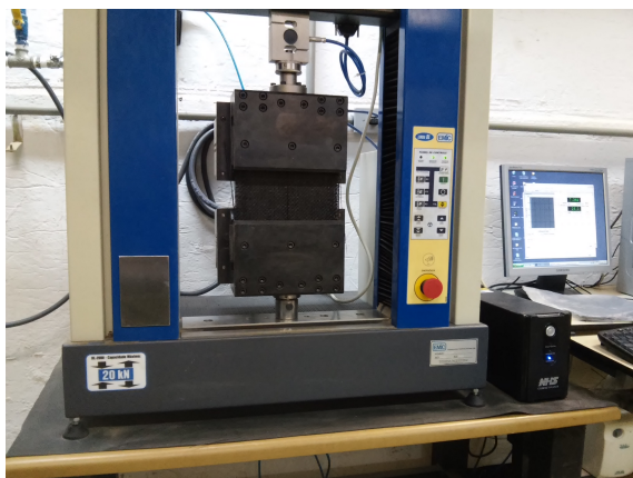
Figura 4. Ensaio de tração no geossintético (UnB).
