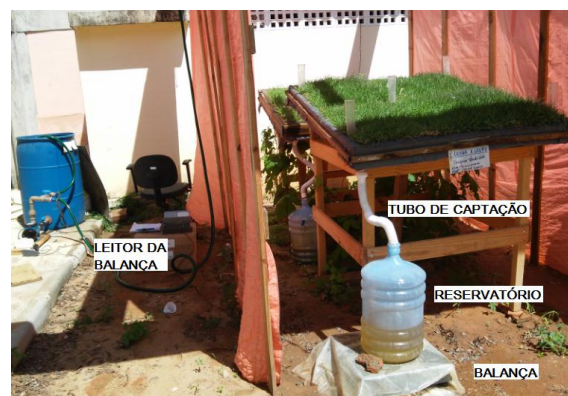
Figura 5. Sistema de captação da água escoada.
