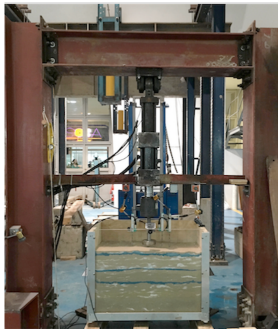
Figura 2 - Caixa de ensaio para o compósito areia-fibra instrumentada.
