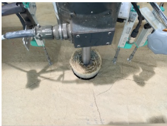
Figura 6 - Ruptura encontrada para o ensaio da areia.
