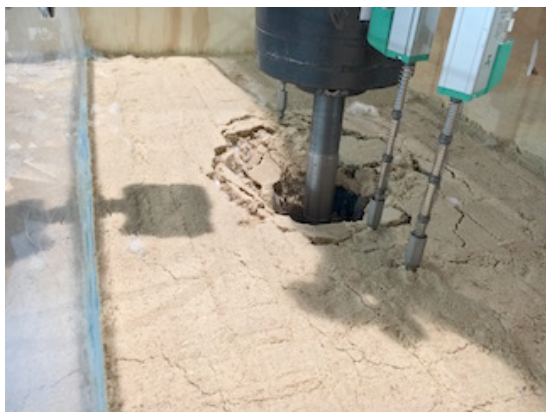
Figura 7 - Ruptura encontrada para o compósito solo-fibra.
