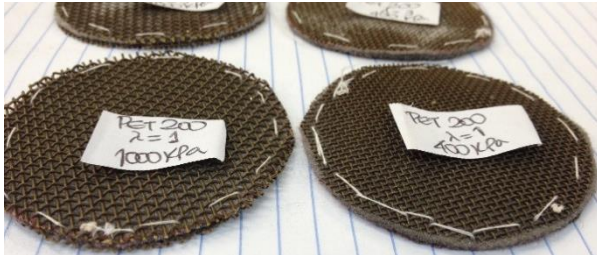
Figura 5. Geotêxtil comprimido para controle da espessura das amostras.
