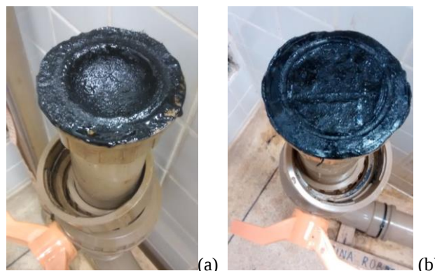
Figura 5. Diferença entre os corpos de prova, após o ensaio com elevada carga hidráulica: (a) sem a tela de suporte; (b) com a tela de suporte.
