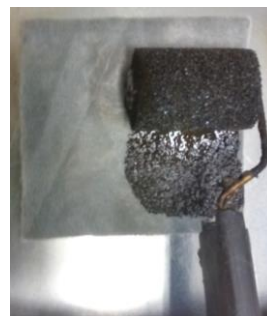
Figura 1. Processo de impregnação com emulsão asfáltica pelo método de espalhamento – Grupo A
