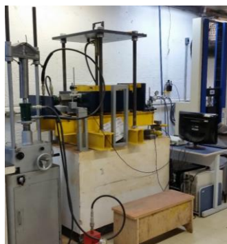
Figura 1. Equipamento de cisalhamento direto em escala média – laboratório do Programa de Pós-graduação em geotecnia da Universidade de Brasília.
