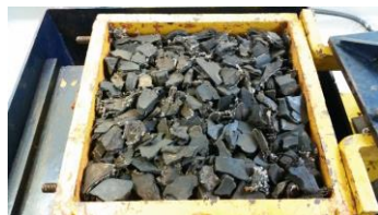
Figura 5. Amostras compostas por pedaços de pneu puro (M100) instaladas no equipamento de cisalhamento direto de média escala.
