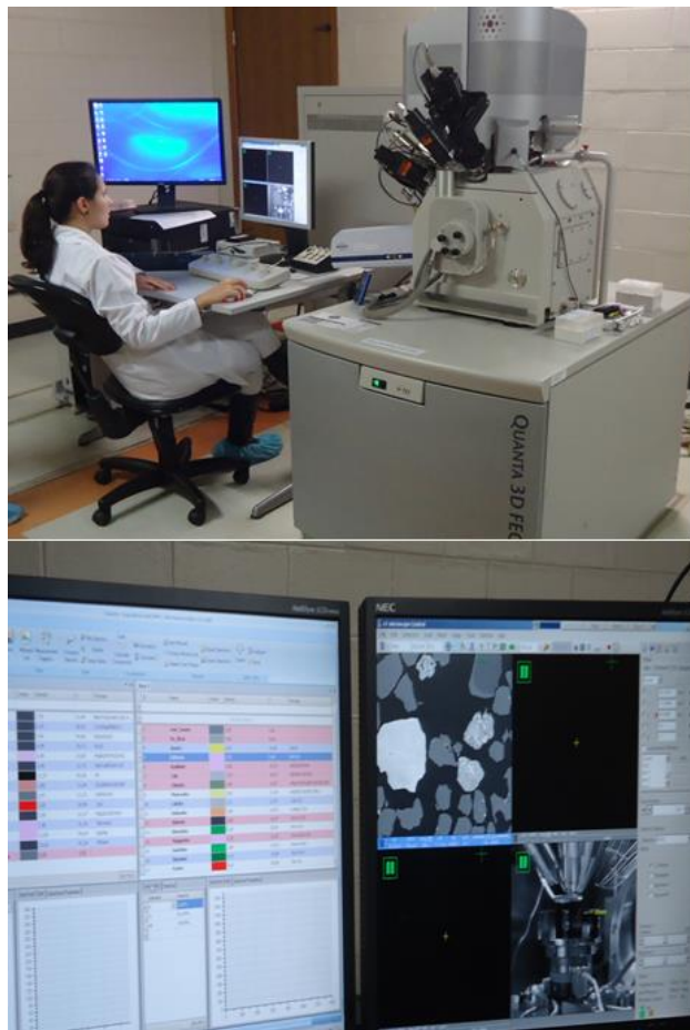
Figura 2. MEV's QUANTA 3D FEG para as algumas análises químicas de microscopia e as telas do MLA 650 utilizado em análises mineralógicas
