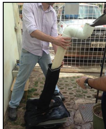
Figura 11. Preenchimento do Tubo de Geotêxtil.
