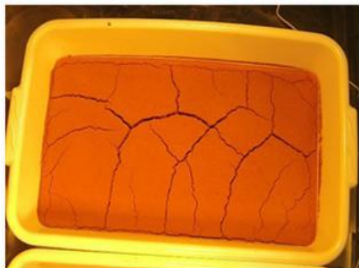
Figura 6. Padrão de fissuramento Solo + 10% RCC
