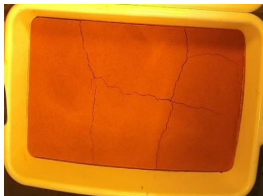
Figura 7. Padrão de fissuramento Solo + 20% RCC
