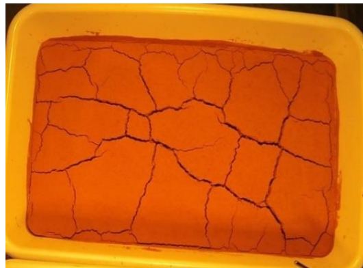
Figura 5. Padrão de fissuramento Solo puro
