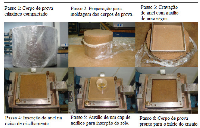
Figura 5. Processo de moldagem do corpo de prova argiloso.
