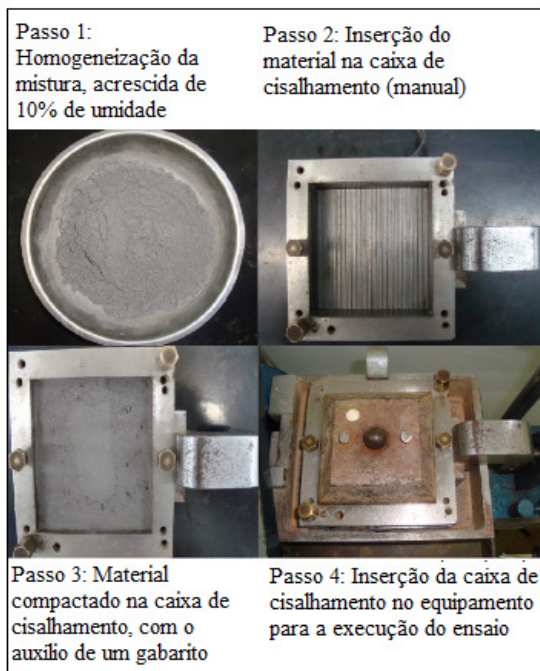
Figura 4. Processo de moldagem do corpo de prova arenoso.
