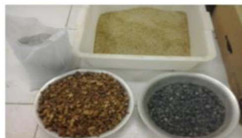
Figura 2. Amostras de Laterita ,Basalto e Areia do Rio Branco usada na pesquisa.
