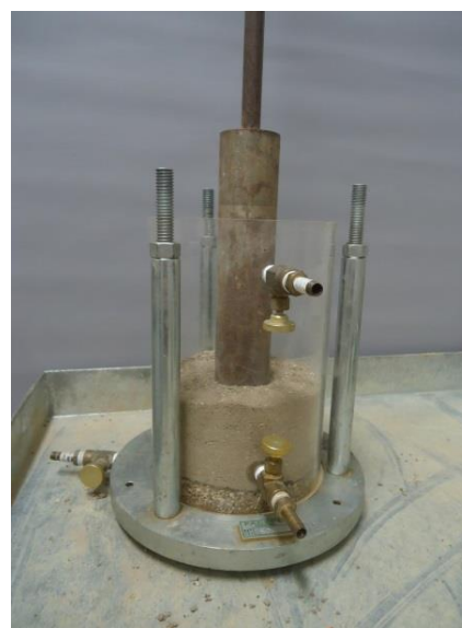
Figura 4. Compactação do corpo de prova para o ensaio de permeabilidade.
