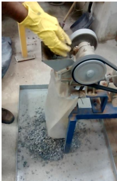
Figura 3. Produção do ARC - britagem dos corpos de prova de concreto.
