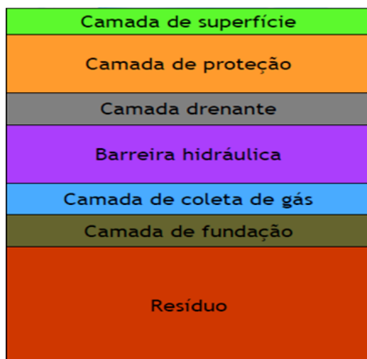
Figura 2. Estrutura convencional da camada de cobertura de um aterro sanitário (MARINHO, 2006).
