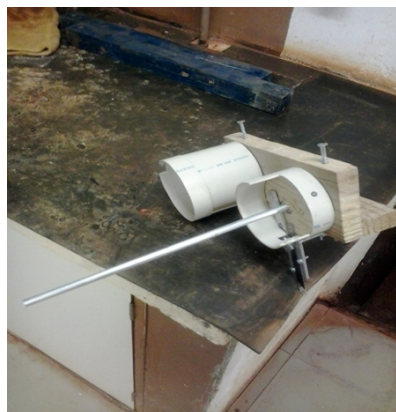
Figura 3. Equipamento para filetar garrafas PET.
