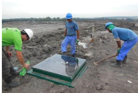
Figura 3: Execução do ensaio de placa de fluxo, no momento de vedação da canaleta de encaixe com água.
