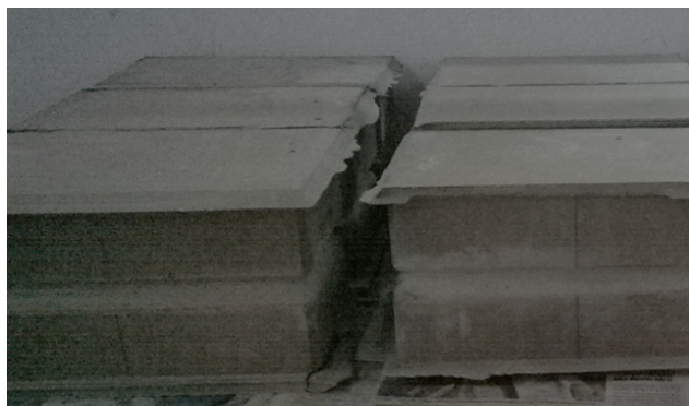
Figura 2 - Prismas preparados para o ensaio de resistência à compressão
