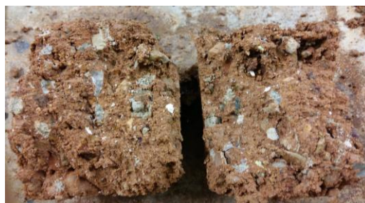
Figura 5. Detalhe de corpo de prova após ensaio de CBR.
