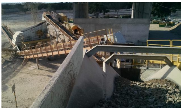
Figura 3. Britador e esteiras que destinam os agregados pós-peneiramento.
