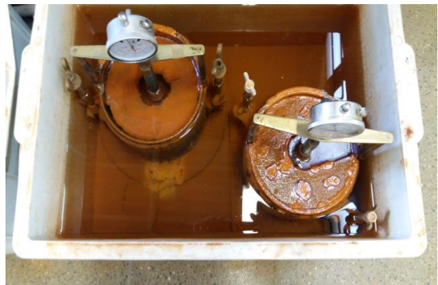
Figura 8. Corpos de provas submersos em água no período de 56 dias.
