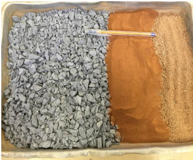
Figura 7. Preparação da amostra para molde do corpo de prova do cisalhamento.
