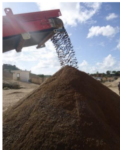
Figura 2. Saída do britador durante a produção de areia grossa de RCD-R.
