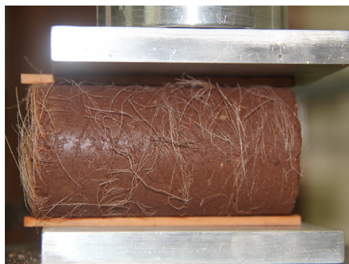
Figura 3. Ensaio de compressão diametral.
