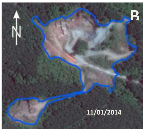
Figura 01: Área minerada 825572/2003, localizada no município de Doutor Ulysses/PR. (A) mina em atividade – nota-se a cava de onde o material é retirado a noroeste e o provável depósito de material de decapeamento a sudoeste. (B) área da mineração abandonada, o que é perceptível devido ao crescimento de vegetação no interior da área anteriormente minerada.
