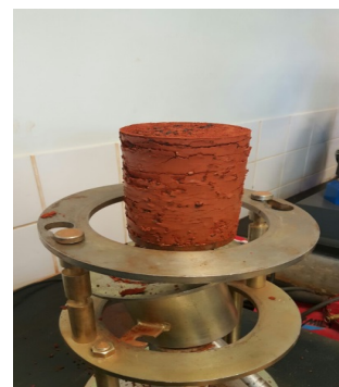
Figura 5. Amostra de solo-pneu granular com teor de 5% de borracha.
