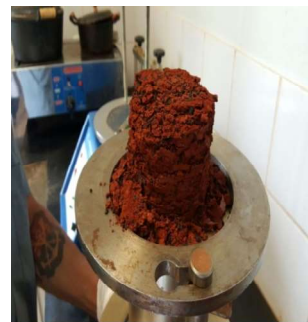
Figura 4. Amostra de solo-pneu granular com teor de 20% de borracha.
