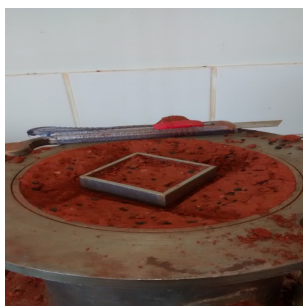
Figura 7. Moldagem de um corpo de prova no cilindro com teor de 3% de borracha.
