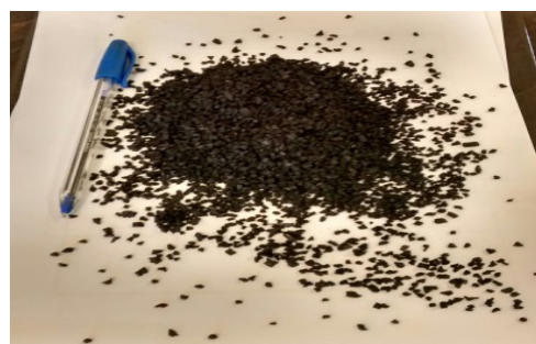
Figura 2. Borracha granular de pneus reciclada.
