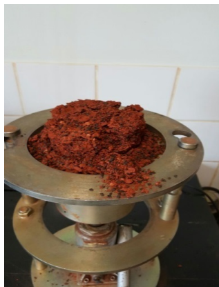
Figura 3. Amostra de solo-pneu granular com teor de 40% de borracha.
