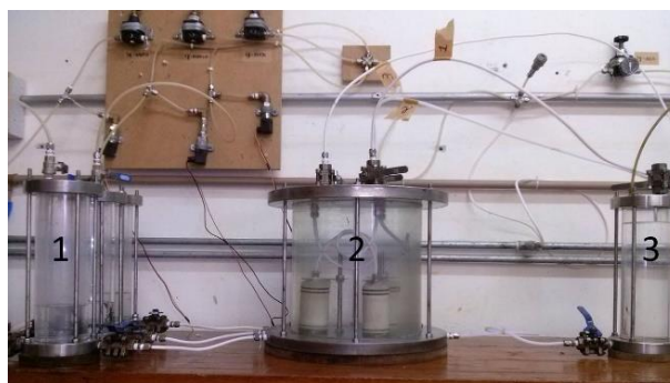
Figura 3. Equipamento de coluna utilizado nos ensaios.
