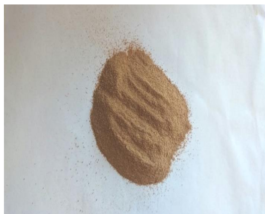
Figura 1. Resíduo de Construção e Demolição Usado.
