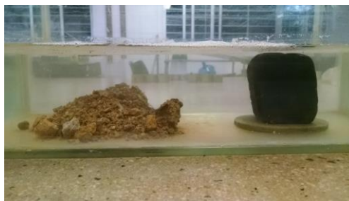
Figura 4. Final do Ensaio por Imersão Parcial.
