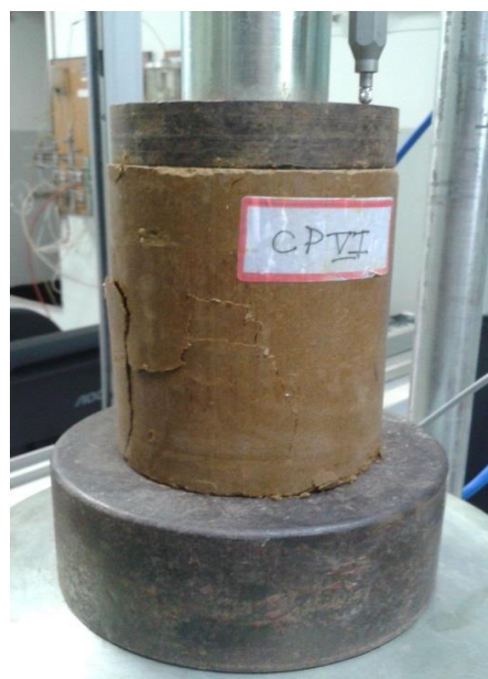
Figura 3. Ensaio de Compressão Simples.
