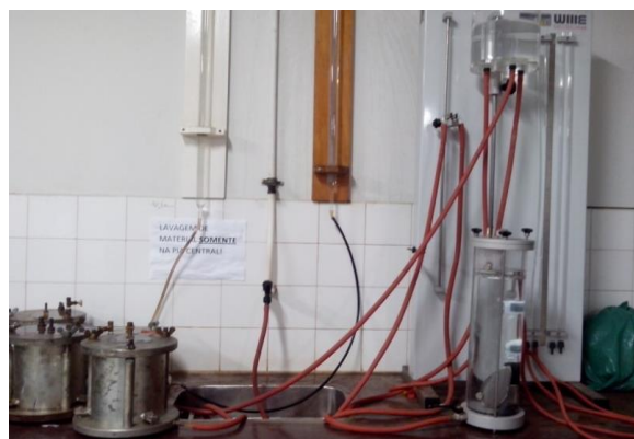
Figura 4. Ensaio de Permeabilidade.
