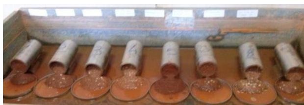
Figura 5. Ensaio de Perda de Massa por Imersão.
