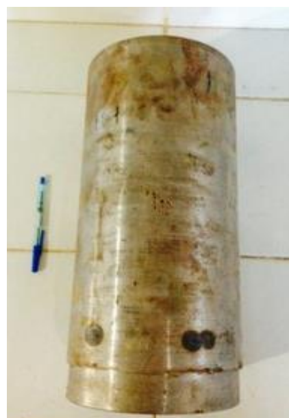
Figura 10. Extensor utilizado para finalizar a cravação.
