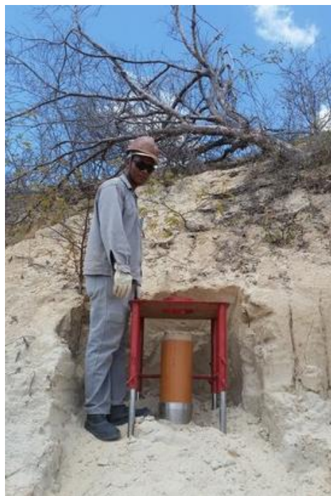
Figura 12. Amostragem de solo friável realizada com o equipamento desenvolvido.
