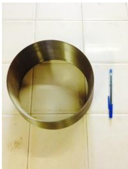
Figura 8. Cabeça Cortante com ponta em formato de bisel.
