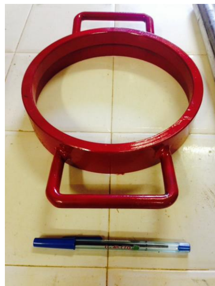
Figura 9. Apoio superior utilizado para cravação do conjunto tubo de PVC e ponteira
