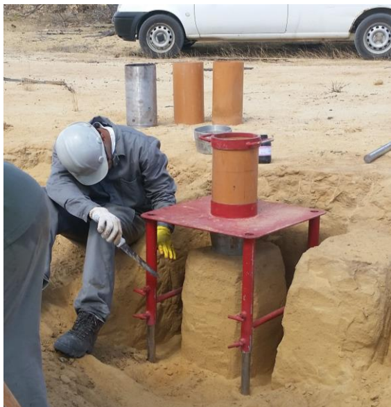
Figura 13. Amostragem de solo compactado realizada com o equipamento desenvolvido.
