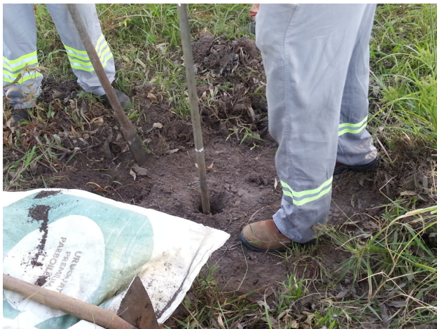
Figura 6. Obtenção de amostras a trado para caracterização geotécnica dos materiais
