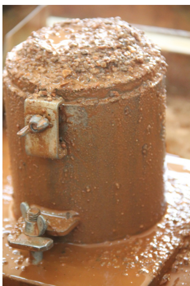
Figura 4. Expulsão de água durante a compactação.
