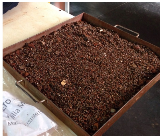
Figura 3. Material retido na peneira de abertura 2,0 mm secando após a lavagem.
