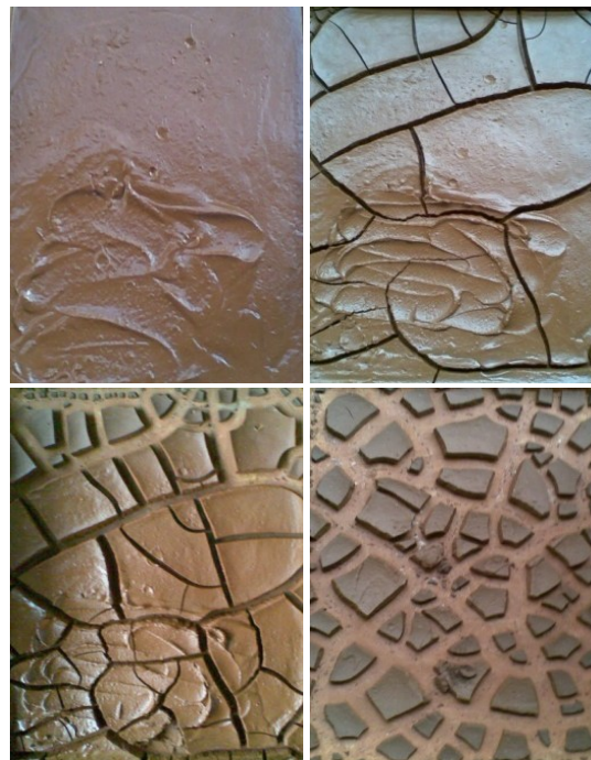
Figura 2 – Transformação do lodo de ETA do estado líquido para sólido
