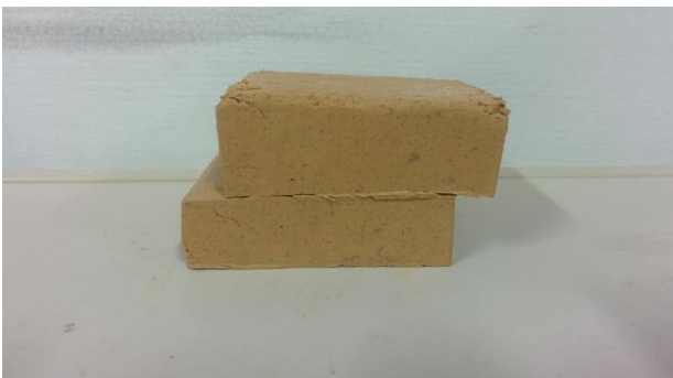
Figura 6. Corpo de prova cisalhado
