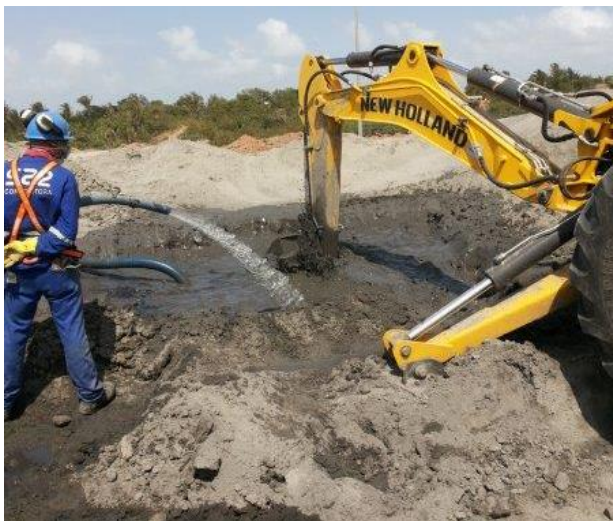
Figura 3 – Teste em campo da hidratação do rejeito de cinzas para preenchimento das geoformas.
