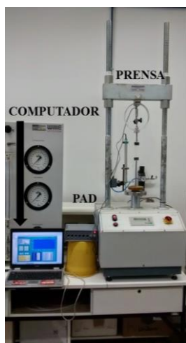
Figura 4. Conjunto de equipamentos utilizados para o ensaio de força de tração do plástico mole
