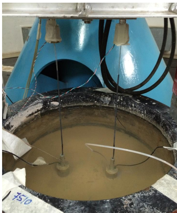
Figura 9- Estacas cravadas para o ensaio de arrancamento na centrífuga geotécnica.
