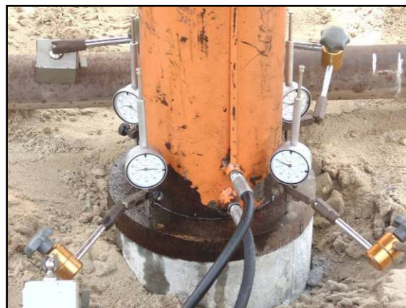
Figura 11: Disposição dos extensômetros na estaca teste.
