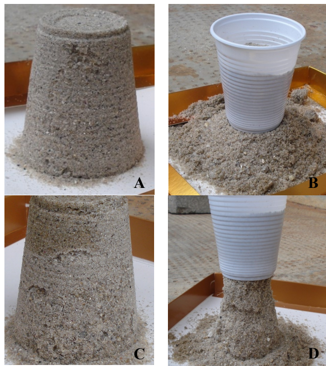
Figura 2. Experimento para ilustrar o conceito de solo reforçado.
