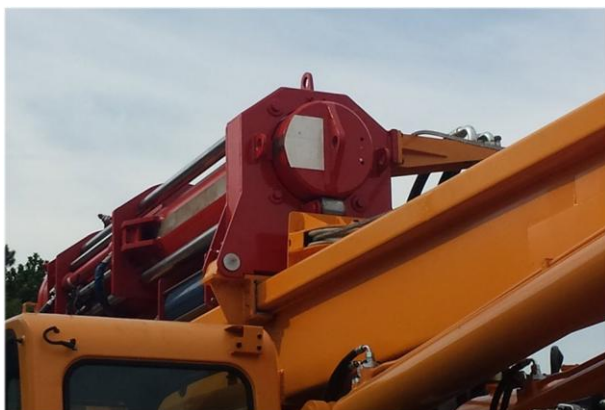
Figura 2. Refletor no topo do pilão do martelo hidráulico
