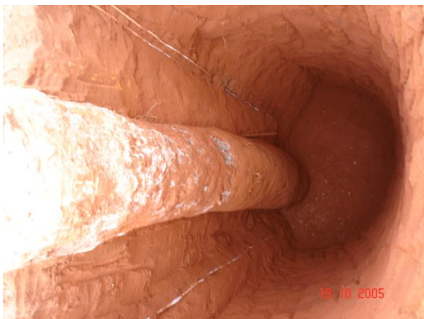
Figura 11. Estaca de SCP Exumada, Mostrando os Medidores de Umidade.
