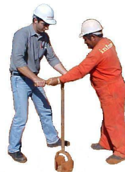
Figura 1. Escavação Manual (trado tipo "concha")
