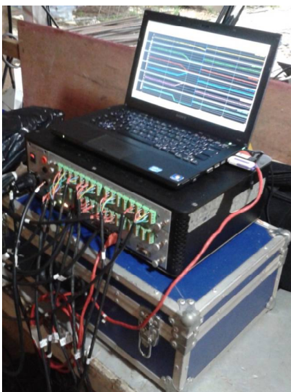
Figura 8 - Sistema de monitoramento durante o carregamento e descarregamento da estaca
